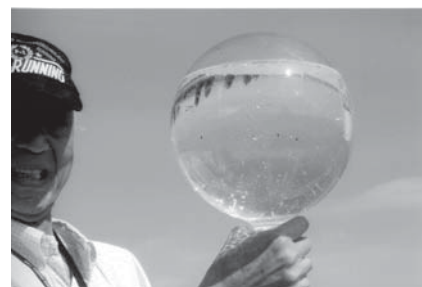
水を使ったトリチェリの実験。フラスコの上に真空の部分ができる
