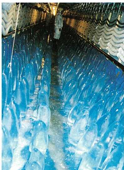
○氷筍(ひょうじゅん)の人工育成 — 富山大学の対馬勝年氏は、氷筍は大きな単結晶になり、単結晶氷の特定の面は摩擦が少ないことを利用した高速スケートリンク作りを提唱し、昨秋エム・ウェーブで実現した。これに向けて黒部のトンネルで、氷筍の人工育成が行われた。
